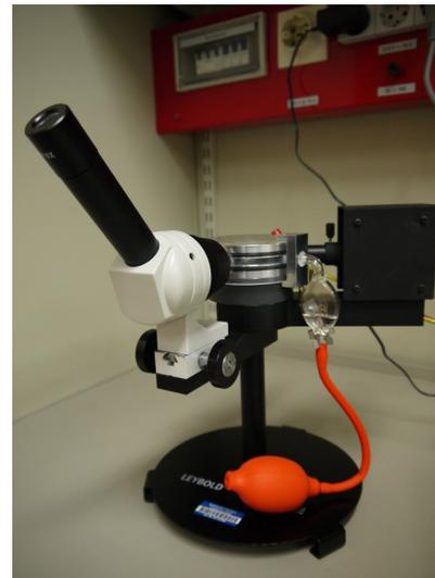
Abbildung 12.1: links: Schematische Darstellung des Millikanversuchs. Die Öltröpfchen bewegen sich je nach angelegter Spannung  $U$  zwischen den beiden Kondensatorplatten nach oben und unten. rechts: Versuchsanordnung. Über die orange Handpumpe werden Öltröpfchen in den mittig zu sehenden Plattenkondensator gebracht und mittels des Mikroskopes beobachtet. Rechts ist die LED Lampe zu erkennen, die für die Beleuchtung für die Dunkelfeldmessmethode sorgt.
