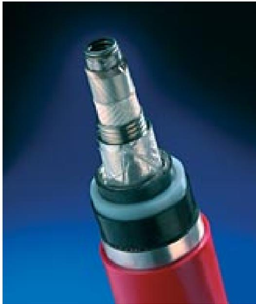
Abbildung 7.6: Supraleitendes Kabel. Ein Beispiel für den operationellen Einsatz der Hochtemperatur-Supraleitung: In einer Stromverteilungsanlage von Kopenhagen, die etwa 50 000 Haushalte versorgt, hat die Firma NKT Cables supraleitende BSCCO-Kabel verlegt. (Quelle: ec.europa.eu)
