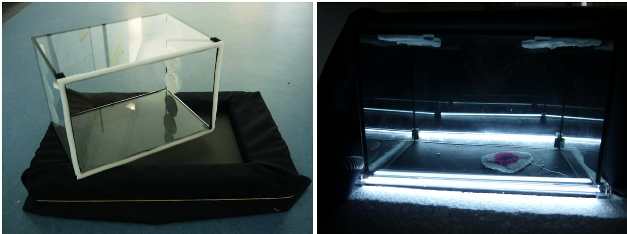
Abbildung 14.3: Die fertige Nebelkammer
