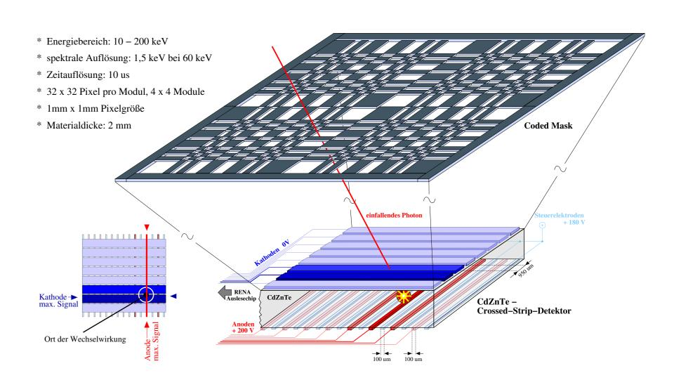
Abb. 4: Schematischer Aufbau des Detektors
