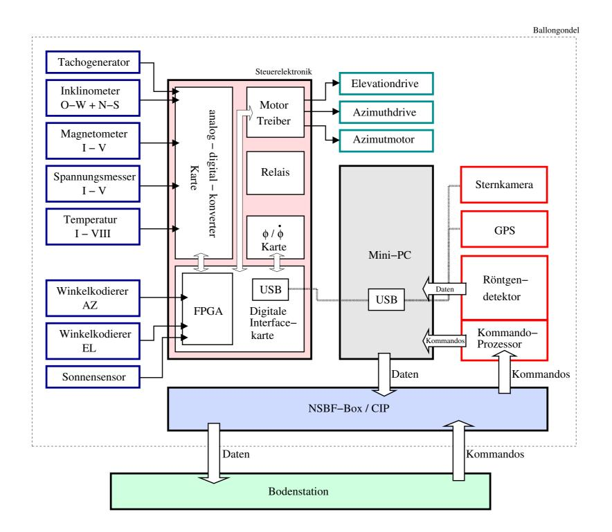
Abb. 2: Übersicht über die Elektronikkomponenten der Gondel
