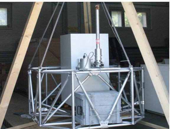
Abb. 3: Baugruppen der Ballongondel: 1)Aufhängung mit Azimutmotor, 2)Detektorlager mit Elevationsmotor, 3)Steuerelektronikbox, 4)Detektor, 5)Sonnensensor, 6)Magnetometer
