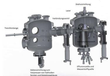
Abb. 6: Querschnitt durch beide Kammer. In der rechten Kammer werden die Kathoden auf die Fenster bedampft, danach in die linke Kammer mit Hilfe eines Greifarms transferiert, wo sie dann mit dem Detektorgehäuse hermetisch dicht mit einer Indiumdichtung verschmolzen werden. Der gesamte Prozess findet im Ultrahochvakuum statt.
