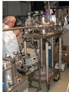
Abb. 7: Vakuumtransportkammer in der die GaN-Substrate vom KIT nach Tübingen transportiert werden. Die Substrate dürfen niemals der Atmosphäre ausgesetzt sein !
