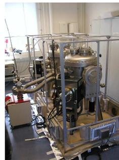
Abn. 3 + 4: Da sich in jeder Vakuumkammer Restgase, Fette und vor allem Wasser ansammeln und den Druck erhöhen, heizen wir die komplette Anlage in einem Heiztunnel mit bis zu 200° C aus. Dadurch verdampfen die Verschmutzungen und der Druck sinkt bis in den Bereich von  $10^{-10}$  mbar ab.
